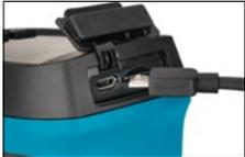
Stromversorgung: USB Kabel (Micro USB)
