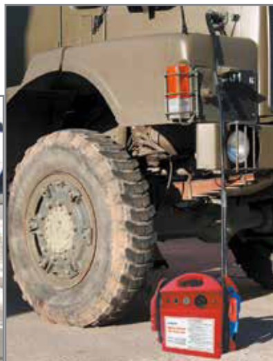
Startvorgang an einem Panzer mit Nato-Doppelstecker
