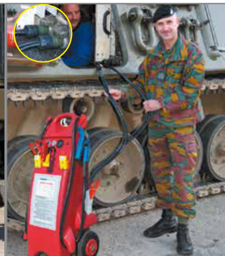
Startvorgang an einem Panzer mit Nato-Doppelstecker
